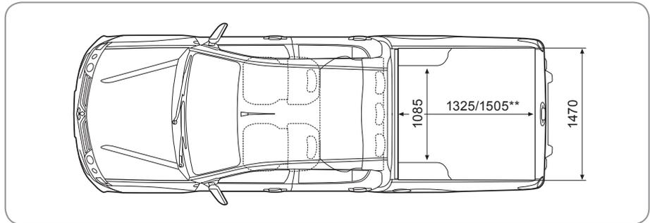
Alle Masse in Millimeter \* Mit Heckstosstange (INTENSE) \*\* Mit verlängerter Ladefläche \*\*\* Mit verlängerter Ladefläche und Stossfänger hinten
